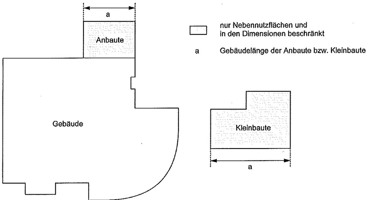
Figur 2.1 – 2.3 Gebäude, Anbauten und Kleinbauten
