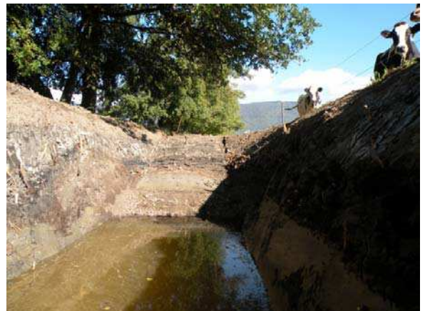
Baggersondierung: Das Grundwasser steht in 2 m Tiefe.
