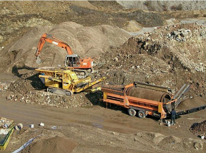
Mobile Aufbereitungsanlage für Bauabfälle
