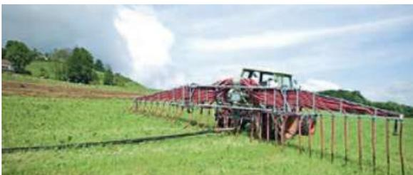
Für die emissionsarme Ausbringung von Gülle wie hier mit einem Schleppschlauch werden Flächenbeiträge ausgerichtet. Die Anzahl der Betriebe, die diese Technik anwenden, und die auf diese Weise gegüllte Fläche haben stark zugenommen. Da die Geräte teuer sind, werden sie meist überbetrieblich eingesetzt.
