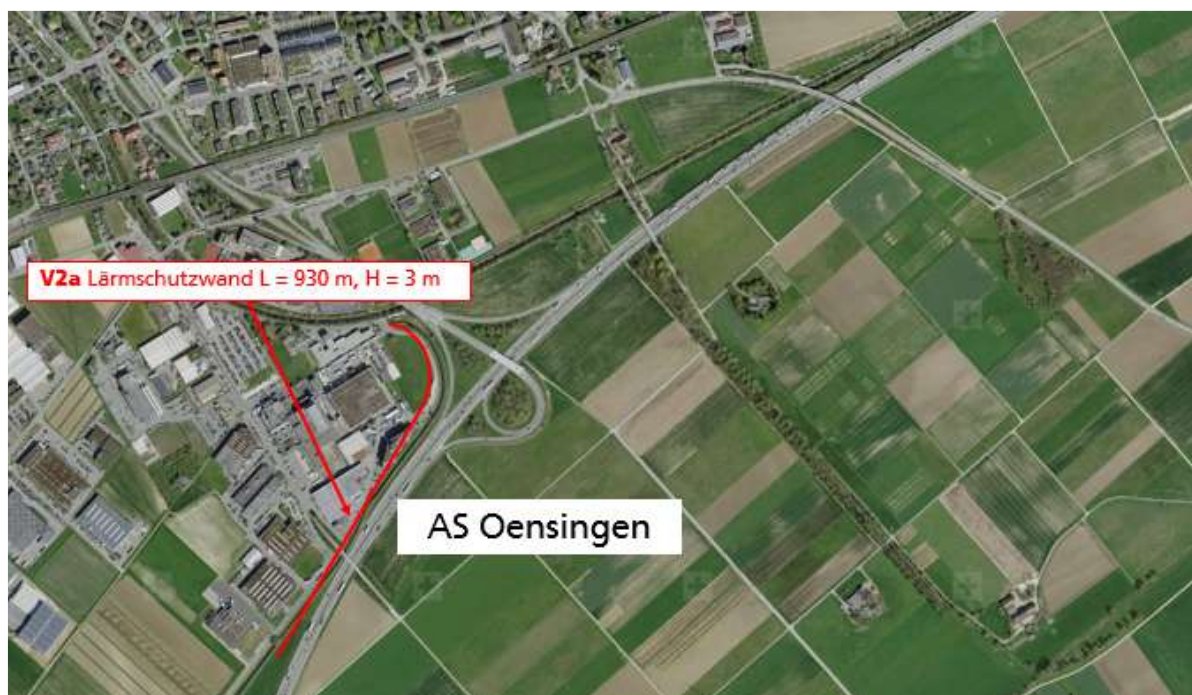
Abbildung 9: Neubau Lärmschutzwand Oensingen West (V2a)
