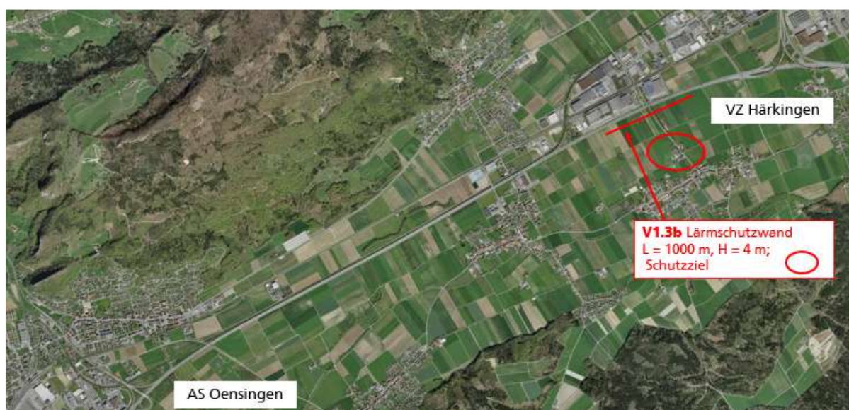
Abbildung 7: Neubau Lärmschutzwand Neuendorf Süd (V1.3b)
