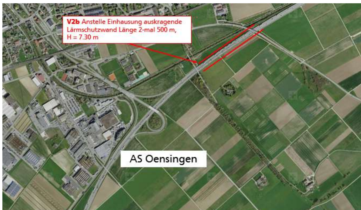
Abbildung 5: Neubau Lärmschutzwand mit Auskragung Oensingen / Kestenholz (V2b) als Alternative zur Einhausung Oensingen (V1.2)
