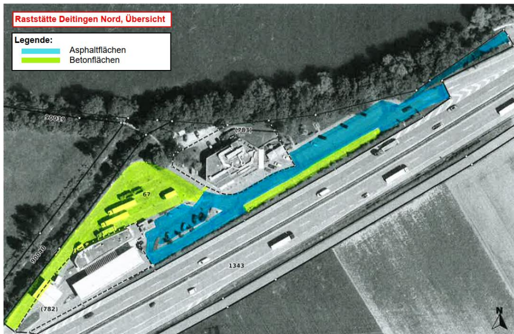
Abbildung 4: RS Nord, Übersicht Belagsflächen
